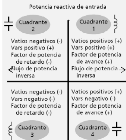
Convención de signos IEC del factor de potencia
